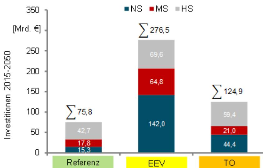
ABBILDUNG 11: INVESTITIONSBEDARF BIS 2050 JE SPANNUNGSEBENE IN DEUTSCHLAND
